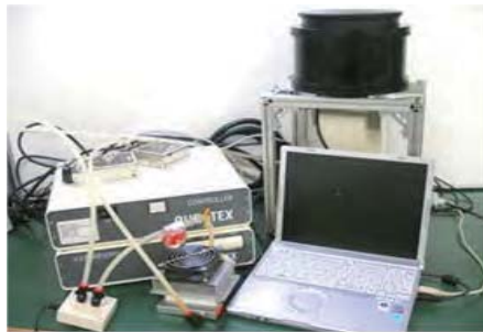
図 2 可搬型蛍光 X 線分析装置
