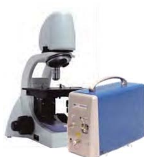
図 3 可搬型顕微ラマン分光分析装置
