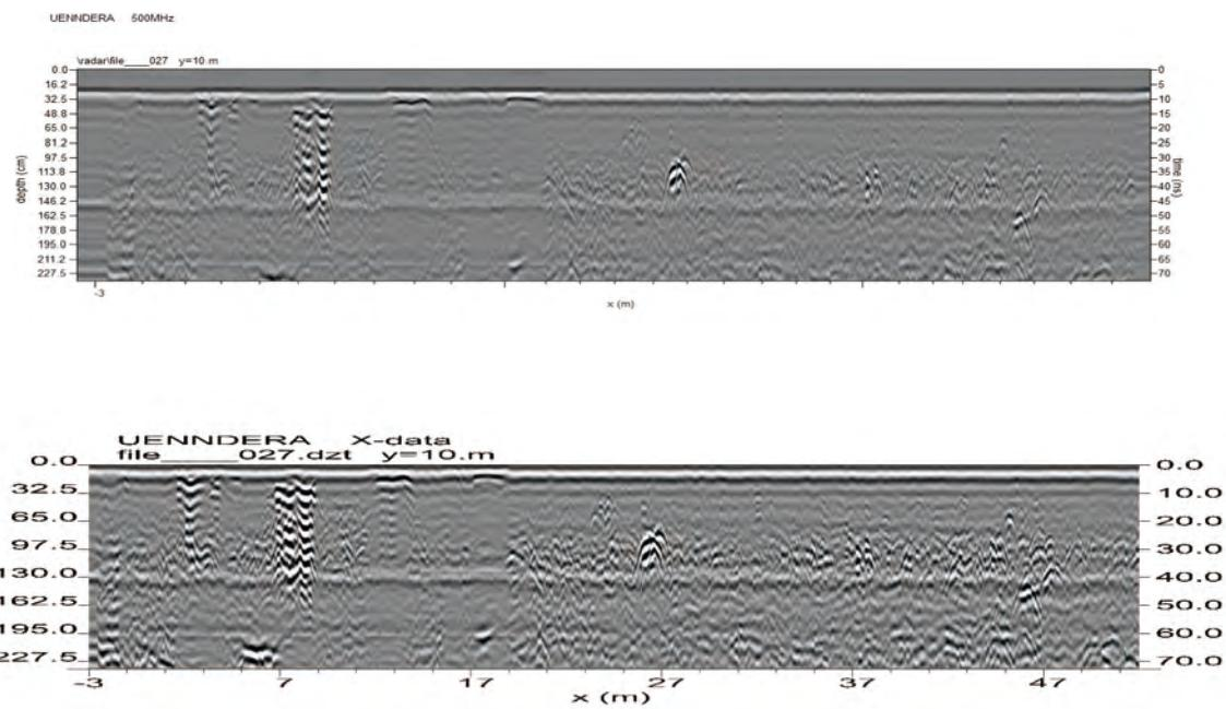
図3 レーダーグラム プロファイル（上：Raw データ 下：Resample データ）
