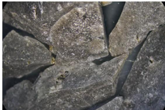
図 41 姫島達磨山ガラス質安山岩：落射光
