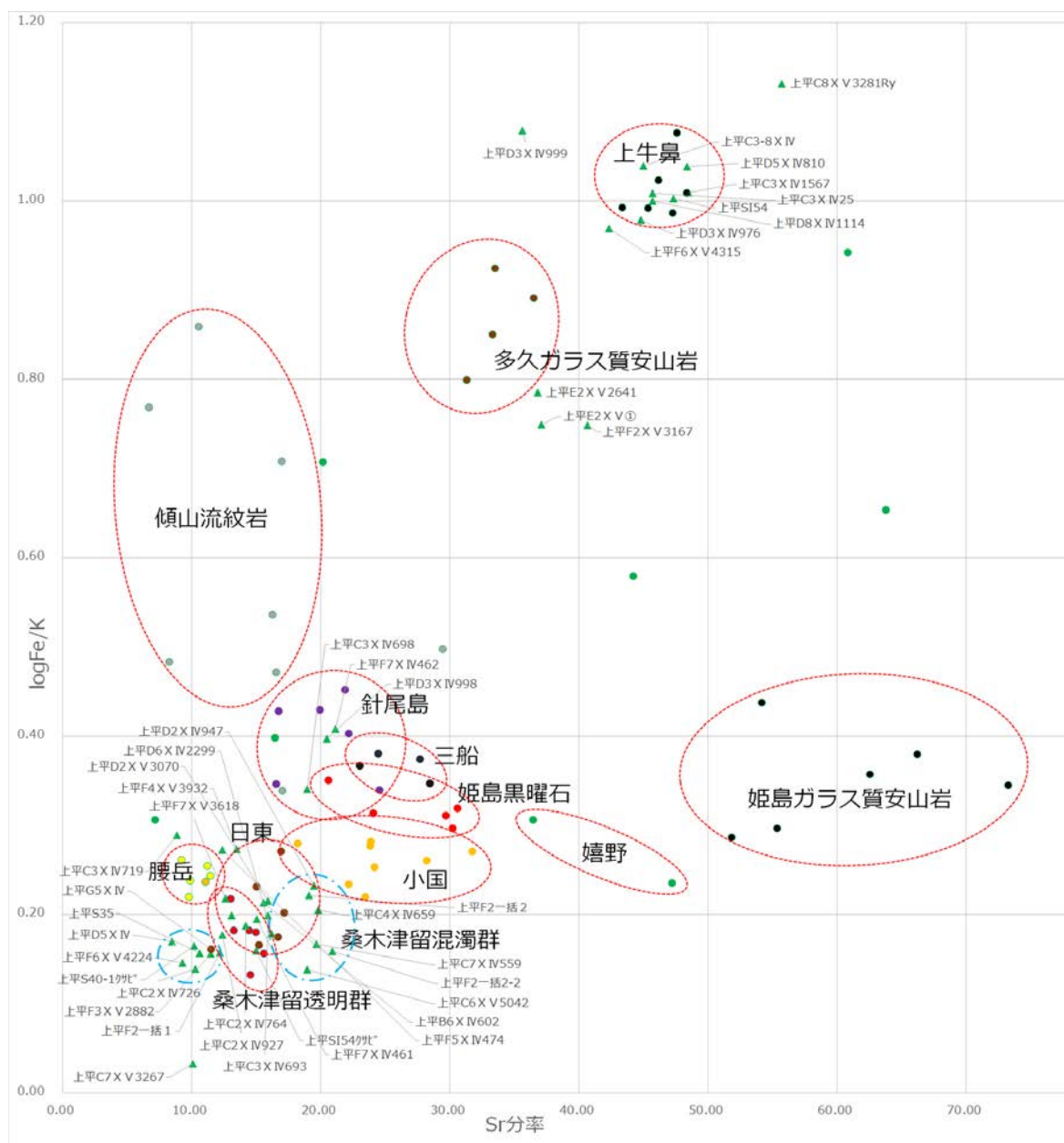
図10 蛍光X線分析による不透過剥片のSr分率ダイアグラム
